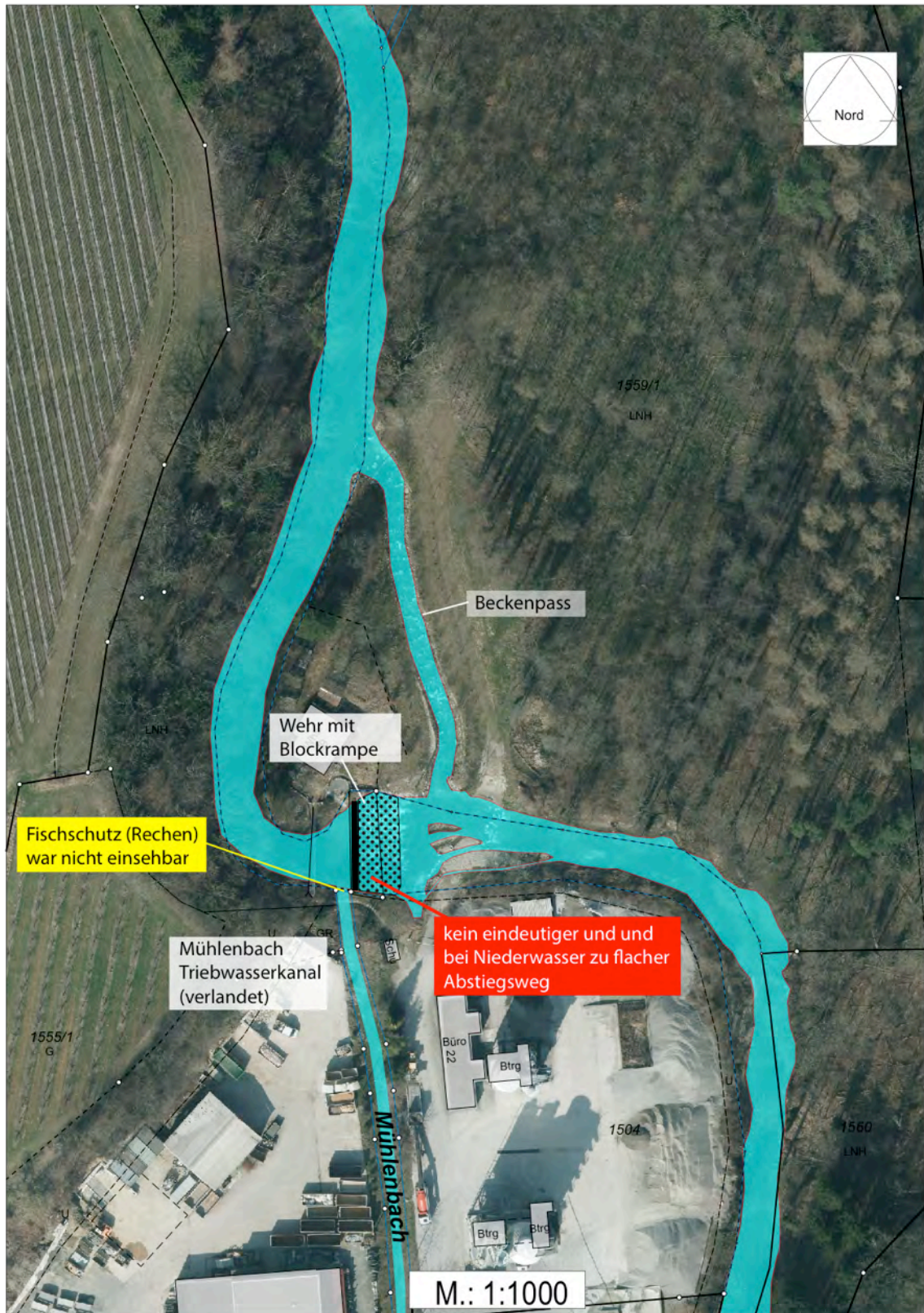
Abb. 5.5.4: Wehr Hammerstatt, Zusammenstellung und Lokalisierung prioritärer Defizite bei der Fischdurchgängigkeit.
